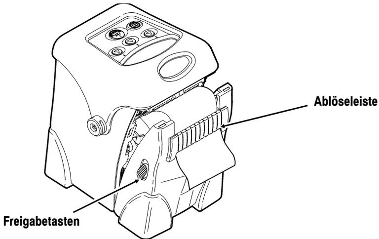
Die Ablöseleiste muss geöffnet sein. Falls dies nicht der Fall ist, drücken Sie an den an beiden Seiten des Druckers befindlichen Freigabetasten nach oben.
