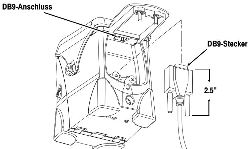
3. Geben Sie das Kabel in die Kabelaussparung.
