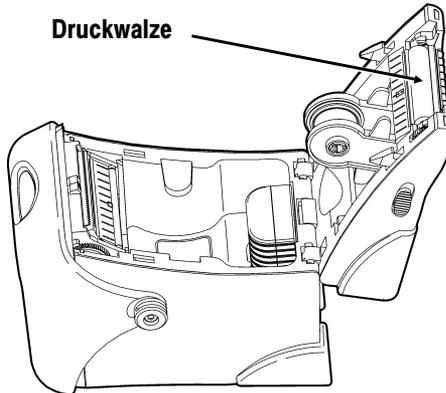
7. Reinigen Sie den Sensor für Einzelmodus und schwarze Markierungen mit einem sauberen, weichen, mit Isopropylalkohol angefeuchteten Tuch oder einem Reinigungstift.
