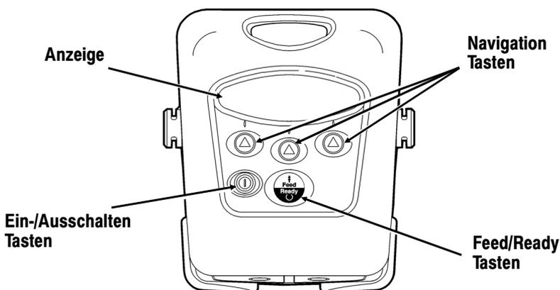
1. Schalten Sie den Drucker **ein**, indem Sie die ⓘ Taste drücken und gedrückt halten, bis die Anzeige eingeschaltet ist.
