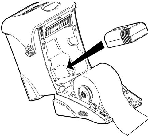
4. Schließen Sie die Etikettenabdeckung, bis die Freigabetasten einrasten.
