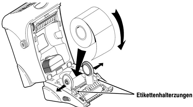
Die Etikettenrolle muss sich, wie auf der Abbildung gezeigt, abrollen, wobei das lose Ende der Rolle durch die Ausgabeförderung geführt wird.
