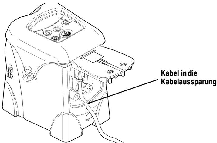
4. Schließen Sie die schwenkbare Tür und ziehen Sie die Schrauben an.
