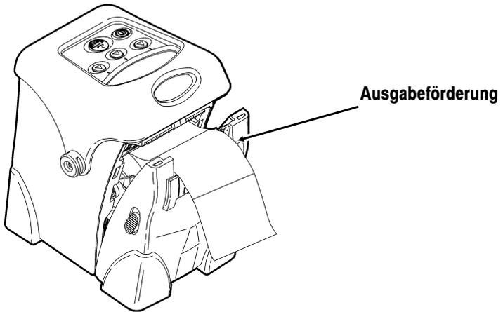
5. Schließen Sie die Etikettenabdeckung, bis die Freigabetasten einrasten.
