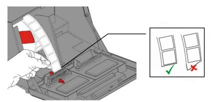
8. Передвиньте лепесток печатного носителя рядом с печатным носителем. Задвиньте рычажок печатного носителя
