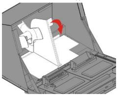
3. Освободите направляющую печатного носителя. Снимите направляющую печатного носителя с держателя носителя.
