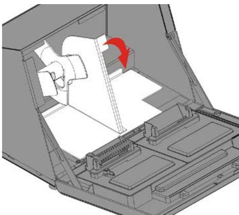
3. Déverrouillez le guide d'alimentation. Retirez le guide d'alimentation du support d'alimentation.
