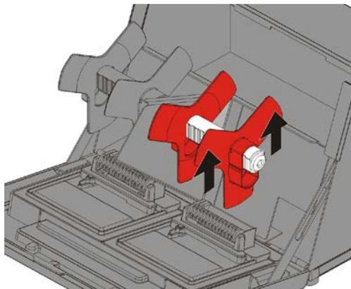
4. Placez un rouleau d'étiquettes (côté étiquette sur le dessus) sur le support d'alimentation.
