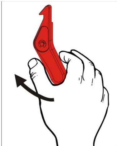
3. Levante el conjunto del cabezal hasta que encaje en su posición.
